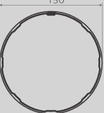
СЕЧЕНИЕ ТРУБЫ ВОДОСТОЧНОЙ D150 мм.
